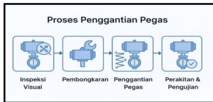
Gambar 4. Alur proses penggantian pegas.
