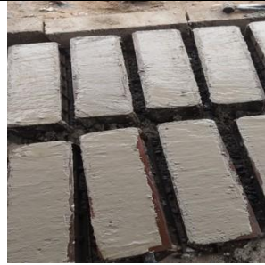
Gambar 6. Proses Pembuatan Benda Uji 12 Balok
