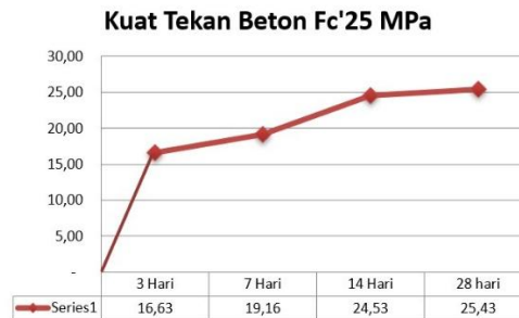
Gambar 9. Grafik Kurva Kuat Tekan Beton
