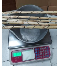
Gambar 3. Hasil Pengukuran Berat Tulangan Kulit Tebu
