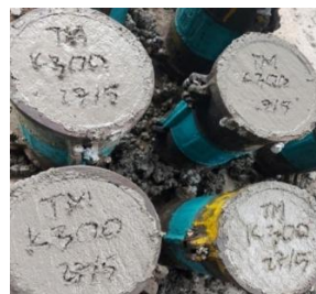
Gambar 5. Proses Pembuatan Benda Uji 12 Silinder
