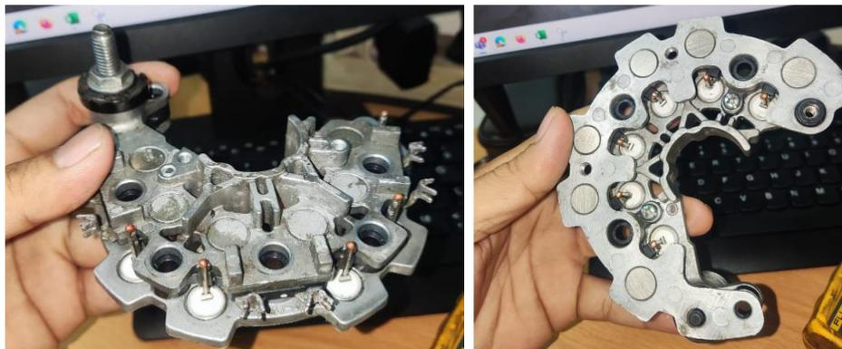
Gambar 2.7 Rectifier alternator
