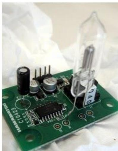
Gambar 1. Modul driver dan Tabung UVTron
