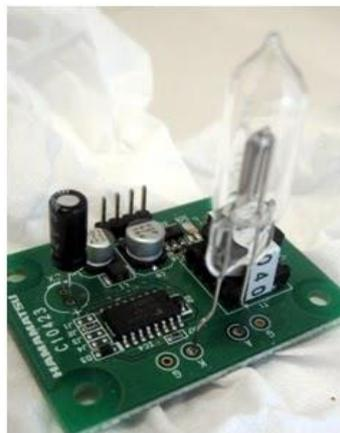
Gambar 9. Sensor dan Modul UVtron
