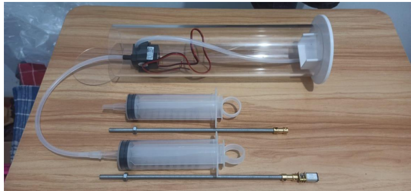
Gambar 5. Komponen penyusun ballast tank
